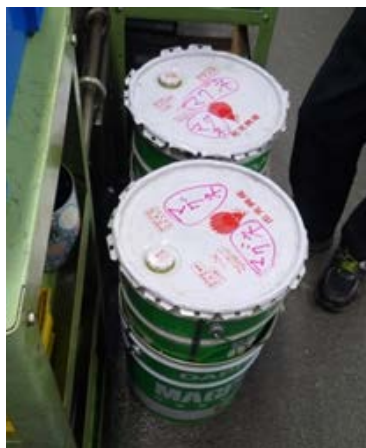
整理清掃された作業場に一定量ごとに適切に保管されたマグネシウム切削屑
