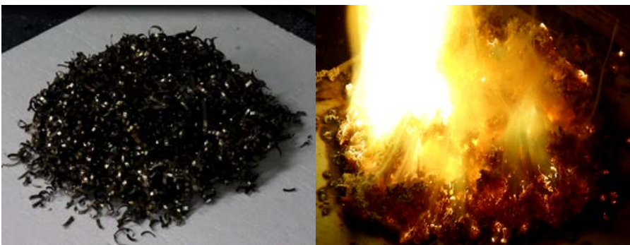
切削屑を強力なバーナーで強制的に着火させた様子
