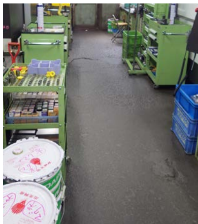
整理清掃された作業場に一定量ごとに適切に保管されたマグネシウム切削屑
