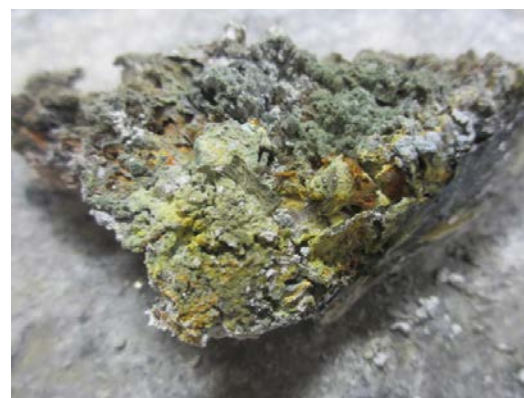
燃焼により生じた窒化物(黄色部分)
