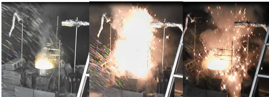
ペール缶内で燃焼中のマグネシウム等の切削屑に放水を行った様子
