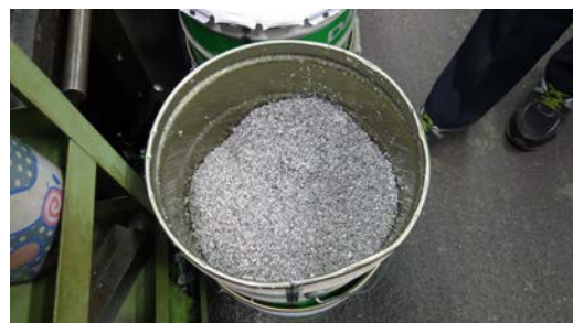
整理清掃された作業場に一定量ごとに適切に保管されたマグネシウム切削屑
